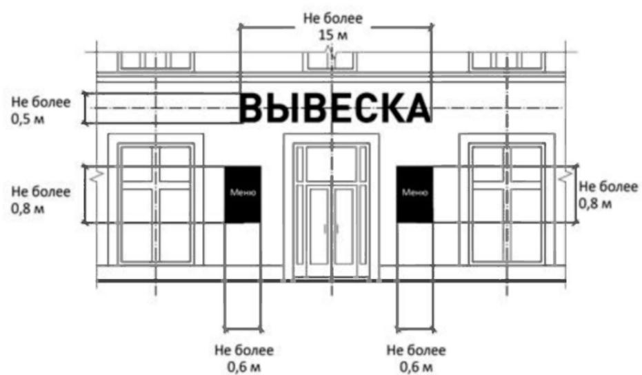
8. При наличии на фасаде объекта фриза настенная конструкция размещается исключительно на фризе, на всю высоту фриза (пункт 11.5. Правил).
