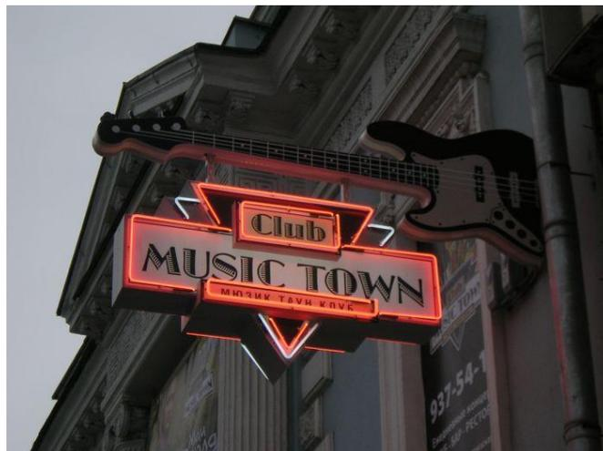
4) Грубо выполненное крепление панели- кронштейна. Видны болтовые соединения, крепление не покрашено в черный цвет или в цвет панели.
